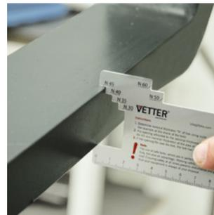
Mit der VETTER Gabelzinken-Verschleißmesskarte treffen Sie schnell und sicher die Entscheidung, ob ein Austausch der Gabelzinke erforderlich ist:
