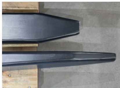
Spitze der Verlängerung angeformt und abgeschrägt
