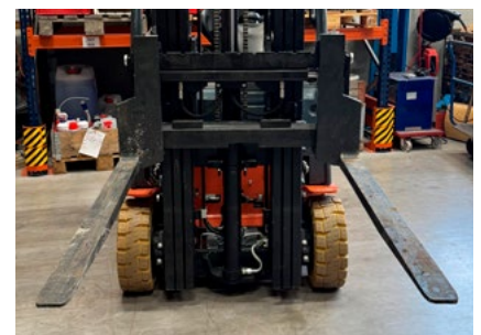
Posicionamiento de la hoja de la horquilla fuera del tablero
