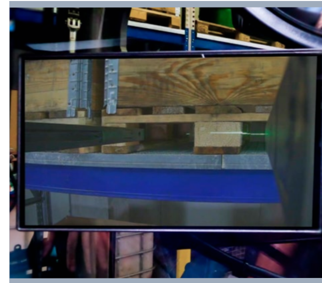
Monitorns vy SideCam. Riktat in sig på lastbärarna längs gafflarna.
