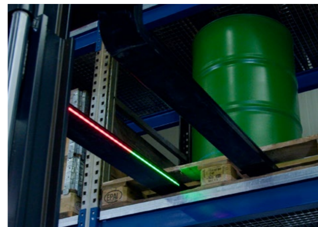
Lysdioder på insidan av gaffelbladet. Fritt programmerbar för att bestämma inmatningsdjupet.
