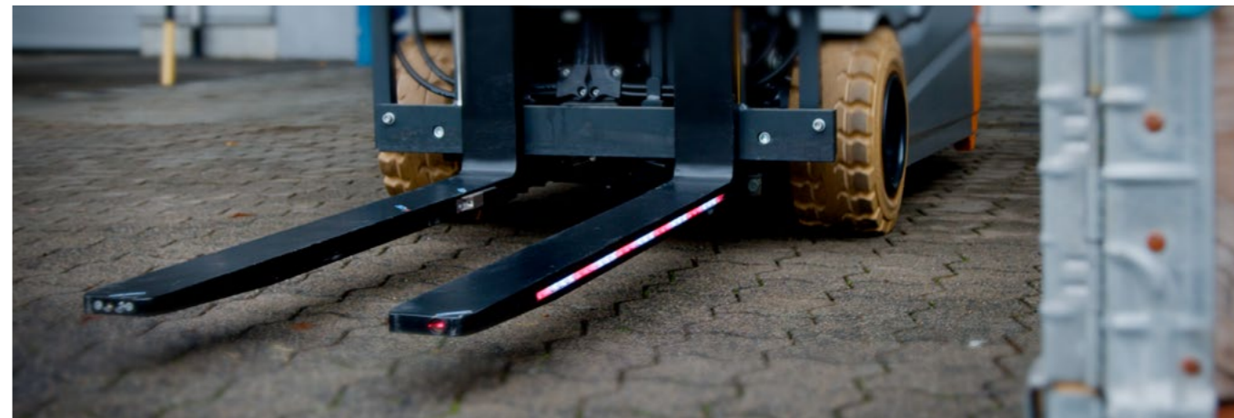
LED-lampor i sidled integrerade i gaffelbladet. Varningsfunktion i röriga situationer.
