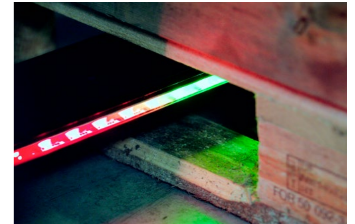
LEDs por el interior de la hoja de la horquilla. Libremente programables para determinar la profundidad de entrada.
