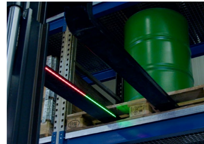
LEDs por el interior de la hoja de la horquilla. Libremente programables para determinar la profundidad de entrada.
