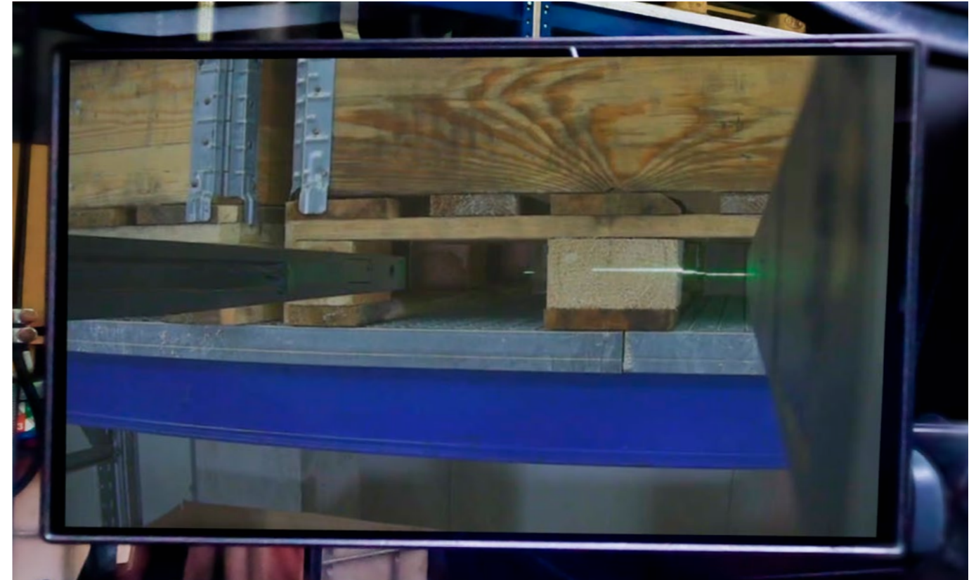
Monitoransicht im Fahrerhaus. Zielen entlang der Gabelzinke
