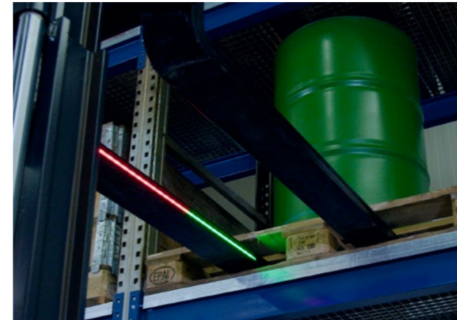
LEDs innenliegend. Frei programmierbar zur Einfahrtiefenbestimmung.
