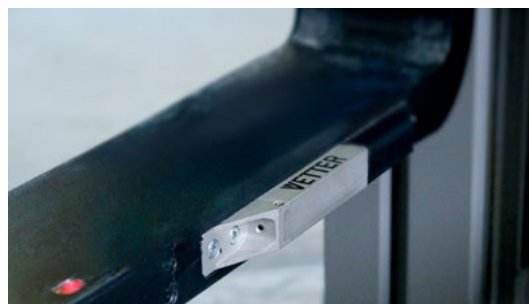
Geringe Abrissgefahr durch teilintegrierten Kameraeinbau
