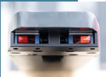
Distanzsensor in der Gabelzinkenspitze
