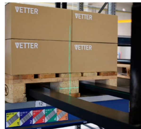
Exakt målinriktning med hjälp av korslasern
