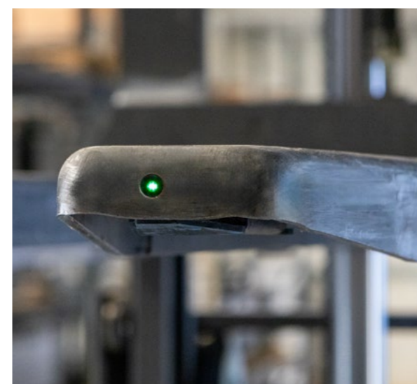
Lasermodul monterad i gaffeln...
