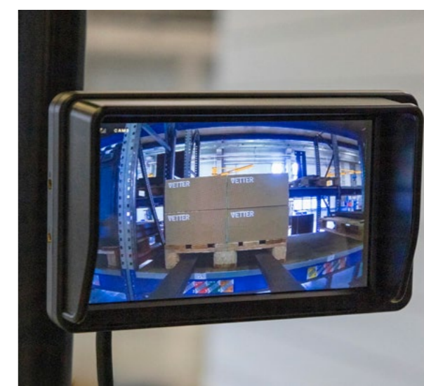
Monitoransicht im Fahrerhaus bei Positionierung am Gabelträger
