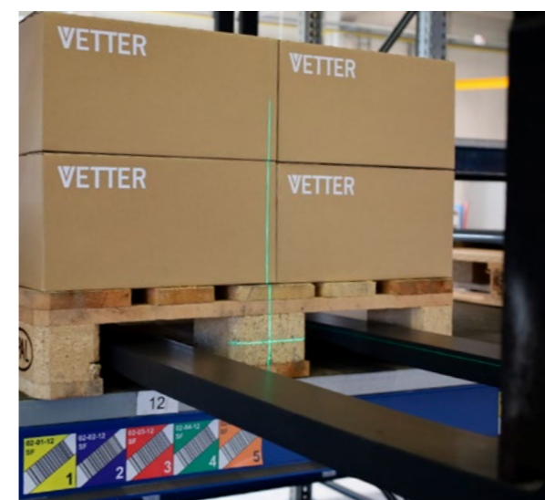
Präzises Anvisieren mittels Kreuzlaser
