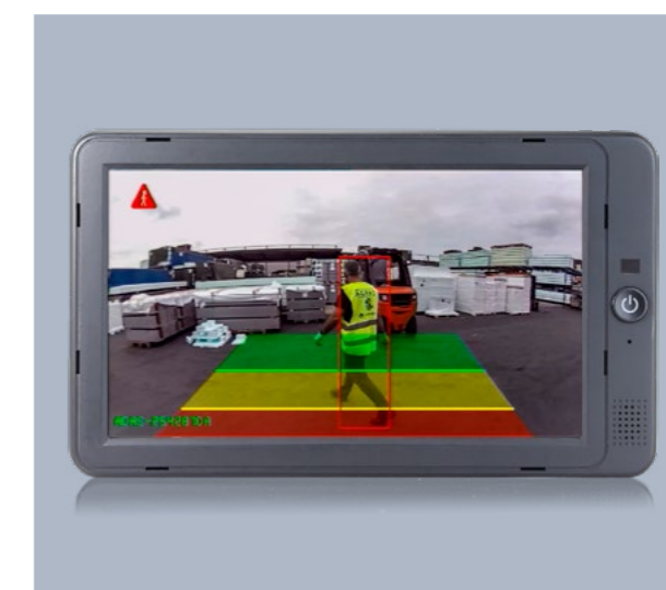
...Person hinter dem Stapler wird per Kamera erkannt
