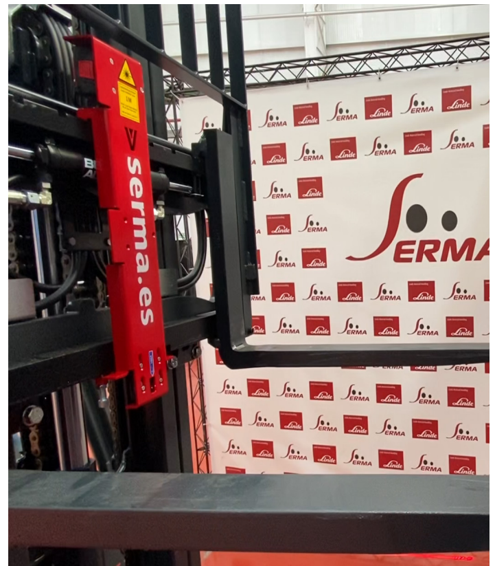
LIZZARD Target: Laser-Assistenzsystem zum Anvisieren von Ladungsträgern.
