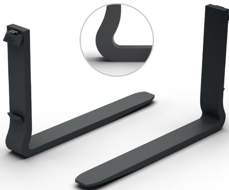
Hay mercancías que pueden sufrir daños por el radio del talón de la horquilla estándar (paquetes de planchas, pallets delicados). **La solución son las horquillas swan-neck:** El radio interior se desplaza hacia atrás mediante el diseño de cuello de cisne. Así la longitud nominal de uso de la horquilla es completamente utilizable sin radios de talón que molesten.
